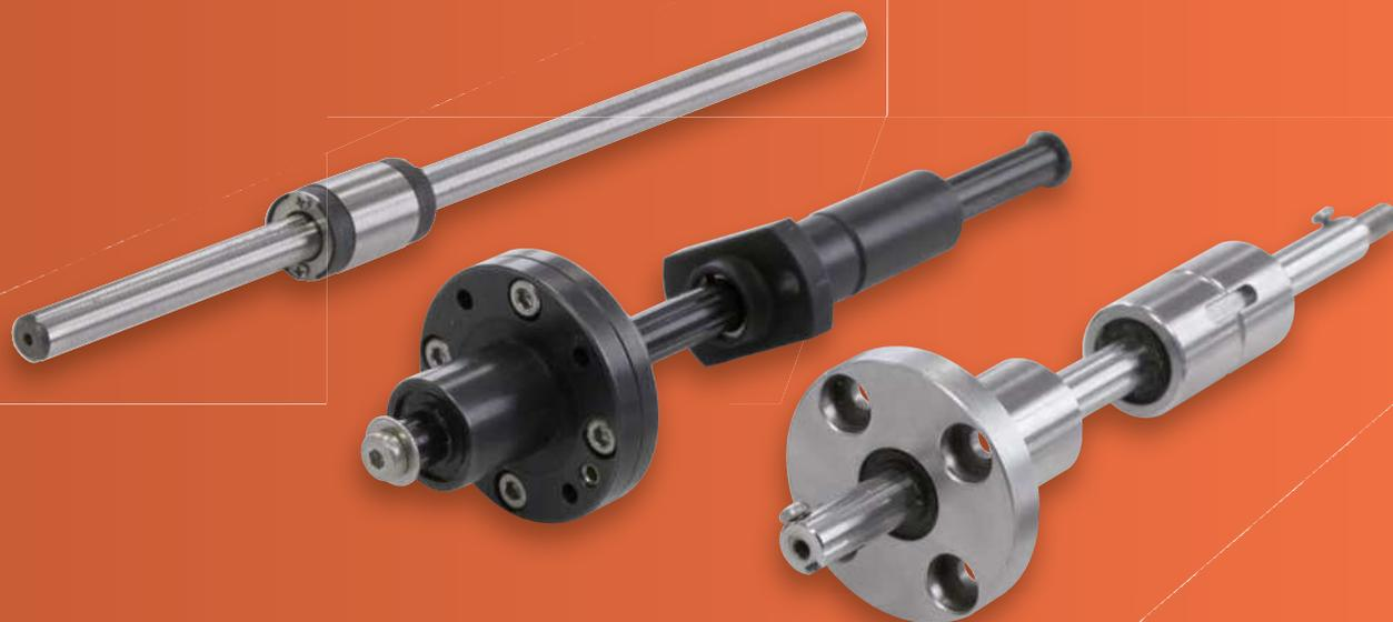
Les arbres à couple résistant sont constitués d'un axe et d'une douille à billes disposant de quatre rainures. Les chemins de roulement sont trempés par induction et ont une dureté superficielle de 60HRc. L'avantage de cette solution est de pouvoir supporter des charges et des couples multidirectionnels tout en conservant une très grande précision.
