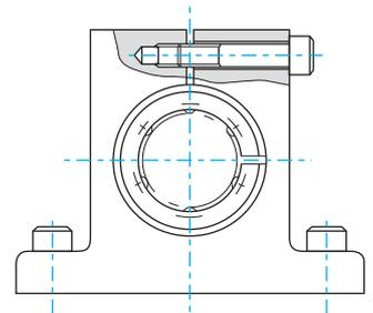
Montage avec douilles ouvertes
